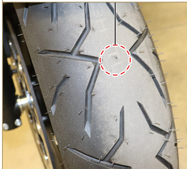
Marcatura di avvertimento sulla superficie
