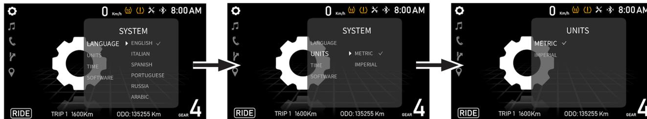
Avec « ✓ » pour l'état actuellement sélectionné, appuyez sur « ▲ » ou « ▼ » sur le mode correspondant, appuyez sur la touche **SET** pour confirmer l'état sélectionné, et appuyez sur **BACK** pour revenir.
